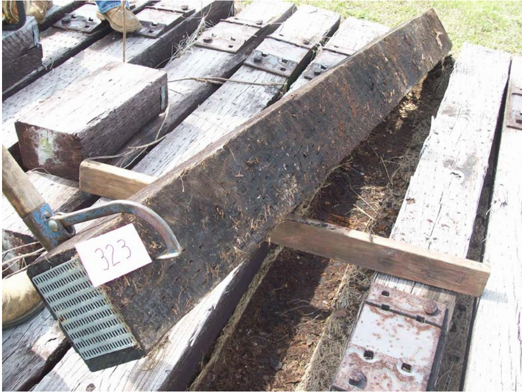
Figure 545 - Tie #323 (Koppers/red oak/P2 creosote).
